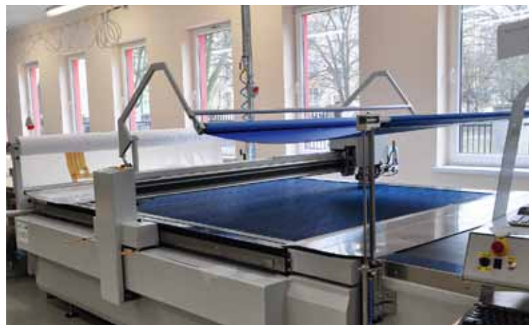
Automatyczna krojownia pozwala na precyzyjne wycięcie materiału.
