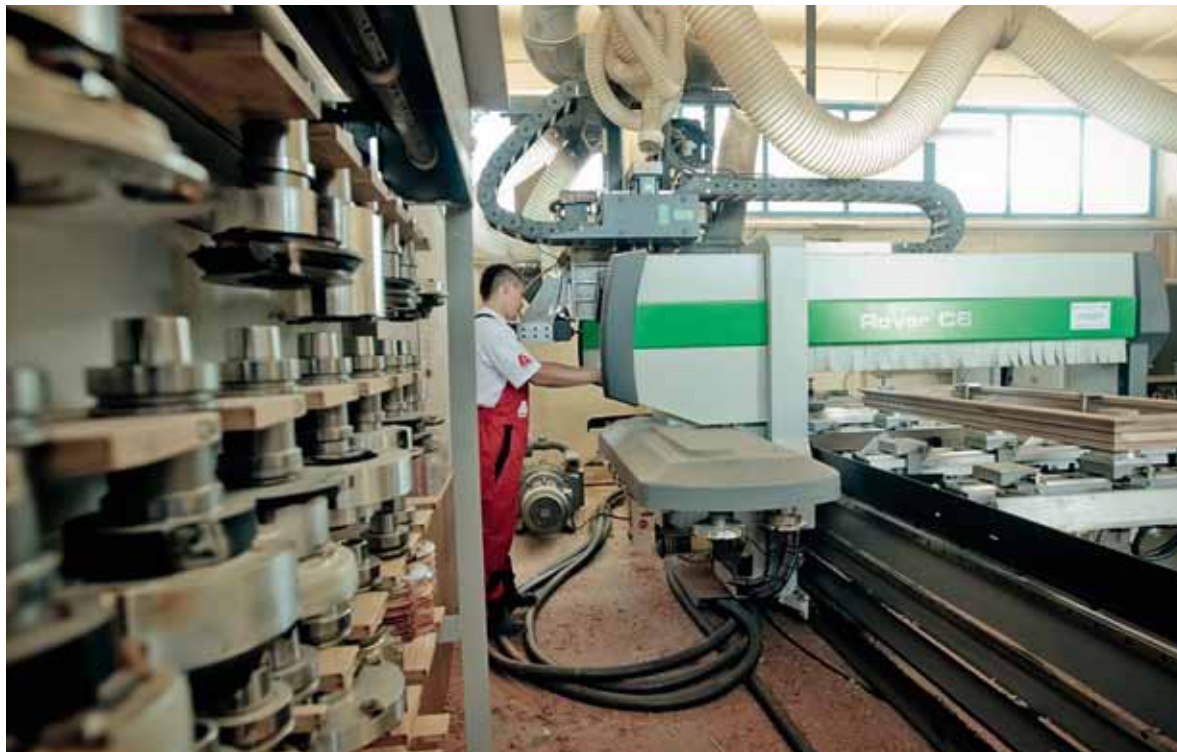
Centrum Obróbcze CNC umożliwia produkcję wysokiej jakości drewnianych okien pasywnych.
